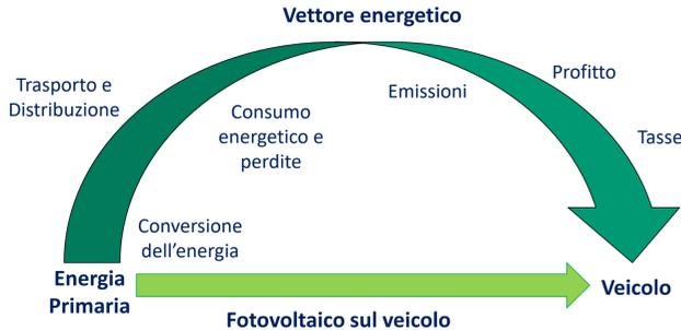
L'uso diretto del fotovoltaico sull'auto è l'unico modo per realizzare un **cortocircuito dall'energia primaria direttamente alle ruote**, senza utilizzare un **veettore energetico**.
